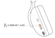
连接一台设备使用超过 5 分钟后,若需要再连另一台设备,可通过连续 4击 (1.5秒内) 上曲键可清除原有的配对信息, 进入重新配对状态。
